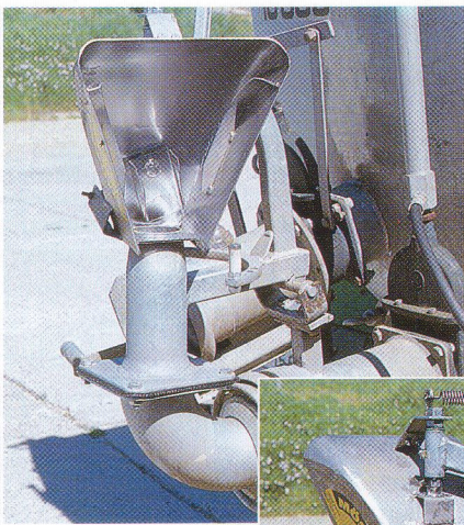
Das U-förmige Leitblech aus Edelstahl wird vom Güllestrom hin und her bewegt.
