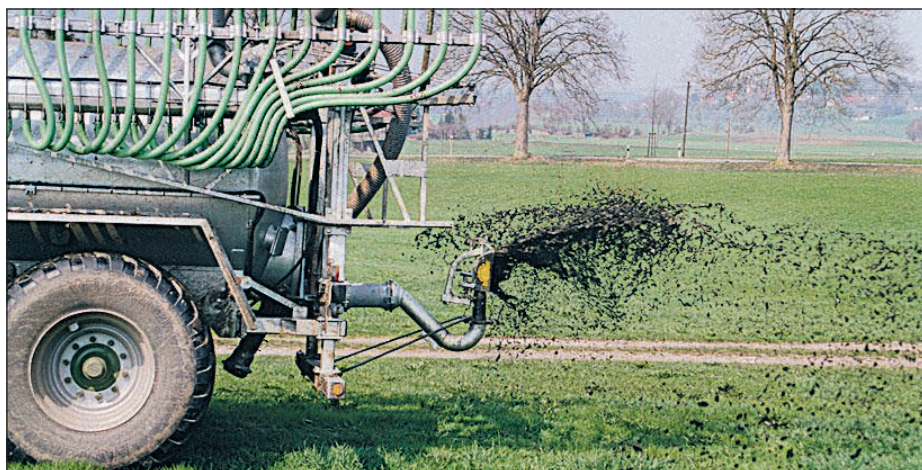
Die großen Tropfen sind hier auf dem Bild bei der Gülleausbringung auf dem Betrieb von Alfred Aldinger mit dem Möscha-Schwenkverteiler gut zu erkennen.
